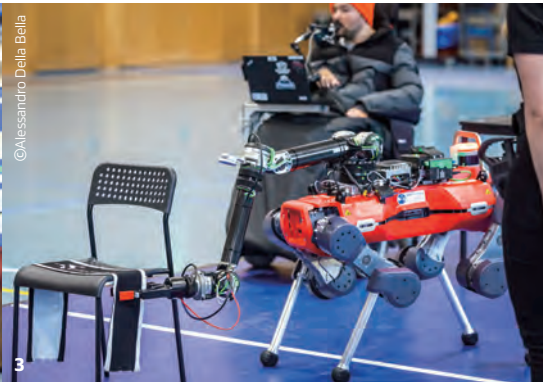
1 울퉁불퉁한 길을 걷고 장애물을 넘고 사다리에 오르는 등의 과제를 수행해야 하는 ‘의족 레이스’. 2 올해 추가된 종목 ‘시각 보조 레이스’. 전문적인 시각 보조 장비는 물론 간단하게는 스마트폰(앱)이 동원됐다. 3 신설 종목 ‘보조 로봇 레이스’ 참가 선수가 입에 문 조이스틱으로 로봇 개의 등에 장착된 로봇 팔을 조작해 수건을 집어오는 장면. 4 ‘휠체어 레이스’ 참가 선수가 험로를 지나 과제 구역으로 이동하고 있다. 5 사이배슬론의 경기별 과제는 모두 일상과 밀접한 일이다. 의수 레이스의 빨래 걸기 과제.
