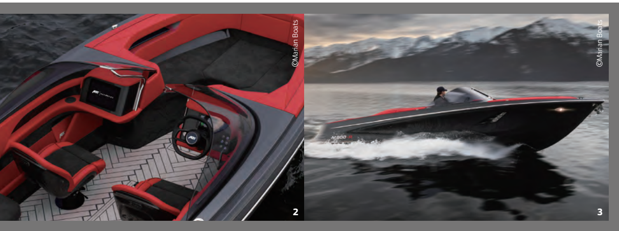
1 마리안의 라인업에는 이미 M800과 M800 스파이더가 있었다. 압트와 협업한 모델에는 압트의 이름과 함께 'R'자가 추가된 것. 2 압트 마리안 M800-R의 콕피트와 선수 벤치시트. 3 최고 85km/h의 속도로 내달릴 수 있는 M800-R은 전기차 충전 규격과 동일한 CCS 초급속 충전을 지원한다.
