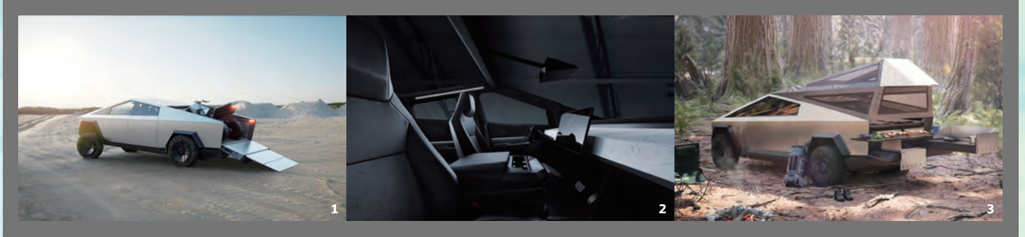
1 사이버트릭은 앞뒤 차축의 에어 서스펜션 높이를 따로 조작할 수 있어 차체를 기울이면 적재함 도어에 내장된 인출식 패널을 이용해 모터사이클도 쉽게 실을 수 있다(고 테슬라가 2019년 발표했다). 2, 3 2019년 발표 당시 사이버트릭은 접을 수 있는 1열 가운데자리를 포함해 3+3 구성이었다. 오른쪽은 사이버트릭의 캠핑 옵션.
