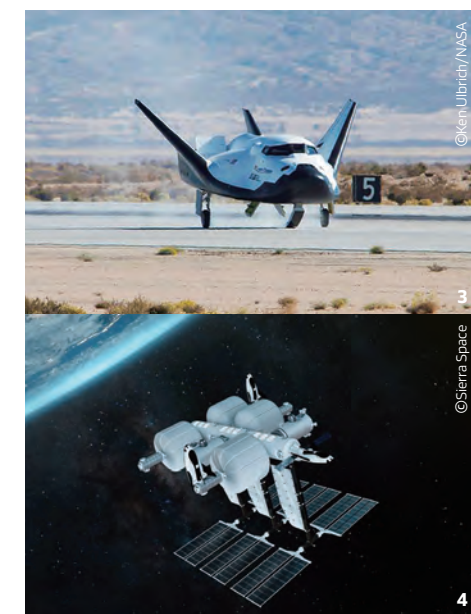
1 슈팅 스타를 매달고 ISS로 향하는 드림 체이서의 상상도. 표면에 부착된 상자들은 비어있(Un-pressurized) 화물칸이다. 2 두 번째 우주왕복선 시대의 여명. 드림 체이서는 로켓 꼭대기에 실려 발사되고, 임무를 마치고 돌아올 때는 활주로에 착륙한다. 3 2017년 미국 에드워드 공군 기지에서 드림 체이서는 수송기에 실려 3.9km 고도에서 낙하한 뒤 활강 착륙 테스트를 진행했다. 4 우주에서 부풀리는 방식으로 발사 시 화물 용적 부담을 줄인 확장형 우주 거주지 라이프 해비타트와 민간 우주정거장 오비탈 리프 상상도.
