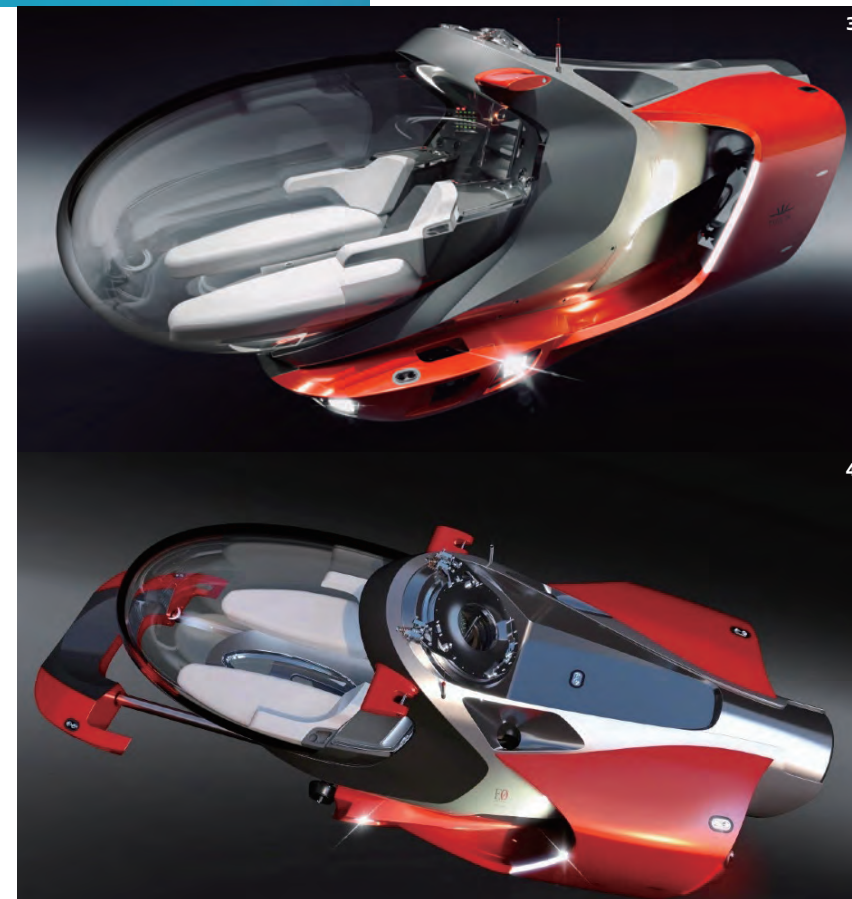
1 그동안 소형 레저 잠수정은 '잠수' 자체를 제공했지만 앞으로는 그 가치가 확대될 예정이다. 2 트리톤이 지난해 출시한 AVA 660은 타원구 객실을 가로 배치한 레저 잠수정이다. 3 투명 타원구 객실을 전진 방향으로 길게 배치한 트리톤의 허큘리스 잠수정. 여객기에 빚댄다면 이코노미석밖에 없던 잠수정계에 비즈니스석이 탄생한 것이다. 4 객실을 바라보는 카메라가 장착된 프런트 스포일러는 선체 안정 및 셀카 촬영 시에 인출된다.
