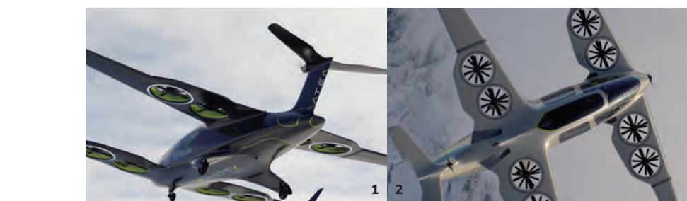
(왼쪽 페이지) 프랑스의 항공 스타트업 어센던스가 개발 중인 아테아는 전기모터와 터빈엔진을 갖춘 하이브리드 항공기다. 1 앞뒤 날개에 달린 팬으로 수직이착륙 가능한 어센던스 아테아. 순항용 프로펠러는 기수와 꼬리날개에 하나씩 달았다. 2 커다란 날개와 하이브리드 동력은 효율적인 운항과 탄소 배출을 저감하는 비결이다.
