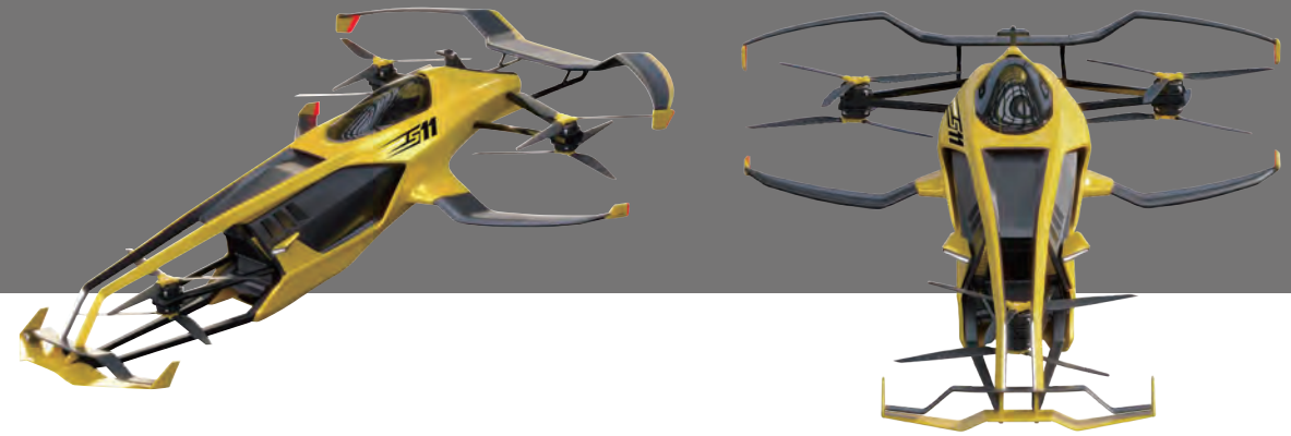
헬리콥터와 항공기 조종사이기도 한 마카의 창업자들이 개발 중인 유인 레이스 드론 S11은 배터리 대신 수소 연료전지를 동력원으로 사용한다.
