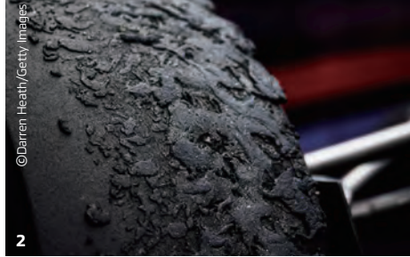
1 2013년 F1 영국 그랑프리에서 4대의 레이싱카 타이어가 폭발하듯 펑크가 나고 적어도 2대 이상이 슬로 펑치를 겪었다. 문제의 원인 중 하나로 지목됐던 당시 실버스톤 서킷의 연석. 2 2013년 마지막 F1 한국 그랑프리에서 우승한 제바스티안 페텔이 연습 주행을 마쳤을 때 레이싱카 오른쪽 앞 타이어에 마블이 잔뜩 붙어 있었다.
