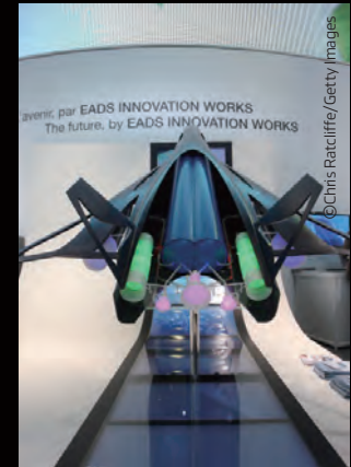
터보팬 제트엔진(초록색), 로켓엔진(분홍색), 램제트 엔진(보라색)을 표시한 제스트 콘셉트
