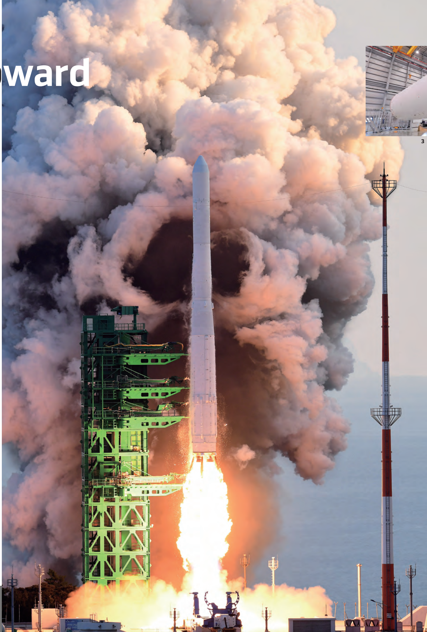
앞 페이지, 1 누리호의 1단 산화제 탱크 내부와 바깥쪽 모습. 액체연료 로켓은 탱크 제조부터가 만만치 않은 일이다. 2 1년 전에 완성된 누리호 1단 인증 모델. 75톤급 로켓엔진(노즐) 4개를 묶어 300톤의 추력을 발휘한다. 3 지난 10월 21일 전남 고흥의 나로우주센터 제2 발사대에서 솟구치는 누리호 길이(높이) 47.2m, 최대 직경 3.5m, 무게 200톤의 3단 액체연료 로켓이다.
