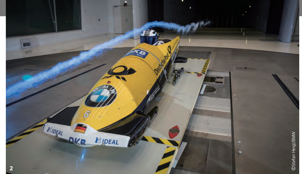
1 오는 베이징 동계올림픽에서도 유력한 메달 후보인 독일 스키레톤 선수 티나 헤르만이 2017년 BMW 풍동에서 공기저항을 테스트하는 모습. 2 2인승 봅슬레이 선수들.
