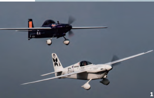
1 기존 에어 레이스에서 사용되는 고기동성 기체를 전기 동력으로 개조해 사용한다. 2 에어 레이스 E는 5km 길이의 타원형 서킷을 5바퀴 도는 비행기 경주다.
