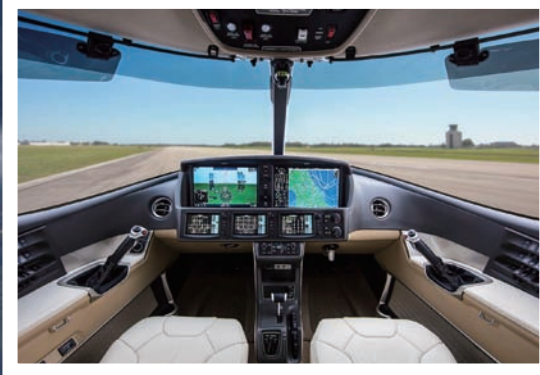
(왼쪽 페이지) X테일이 특징적인 사이러스 비전젯 SF500은 유일하게 출시된 단발 VLJ다. (왼쪽) 터치스크린을 포함한 5개의 디스플레이로 단순화한 콕핏.
