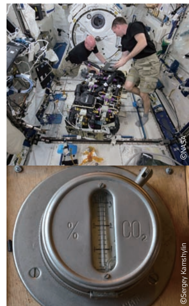
▲ 2015년 국제우주정거장의 우주인들이 이산화탄소 제거 장치(CDRA)를 유지·보수하는 모습(위). 옛날 잠수함의 이산화탄소 농도계(아래).
