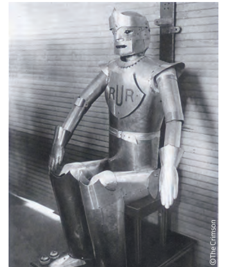
▲ <로봇의 만능 로봇>의 영향으로 1928년 영국에서 만들어진 로봇 에릭(Eric). 일어설 수 있고 간단한 말도 할 수 있었다고.
