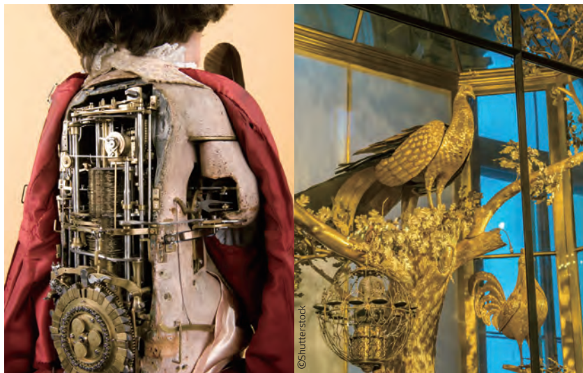
17세기 이후 유럽에서는 오토마톤(Automaton, 복수형은 Automata)이라고 부르던 자동인형이 유행했다. 이는 시계 기술의 발달과 관련이 깊다. (왼쪽) 시계 장인이자 천재 엔지니어였던 자케 드로의 편지 쓰는 오토마톤의 구조. (오른쪽) 상트페테르부르크 에르미타주 박물관에 전시된 황금공작 시계. 날개를 펴는 공작과 닭, 부엉이의 움직임으로 시간을 알려주는 기계다.
