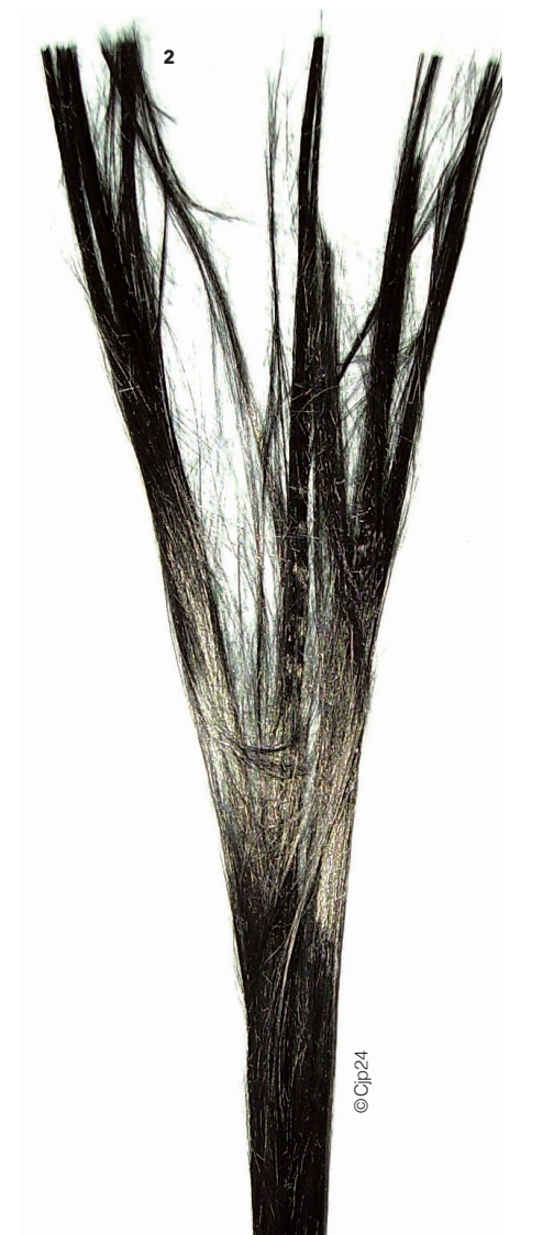
1 이른바 '카본파이버' 특유의 패턴은 탄소섬유로 짠 원단에서 나온다. excludtec.com 2 탄소 원자가 육각 고리 모양으로 결합된 탄소섬유 원사.
