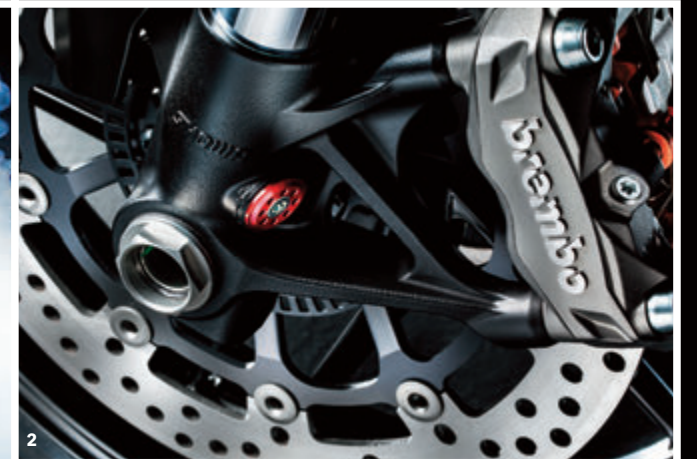
1 한국에 첫 출시된 슈퍼바이크 라인인 899 파니갈레는 디지털 디스플레이가 장착됐다. 2 148마력의 898cc 수랭식 L트윈 엔진과 직경 32cm의 거대한 트윈 디스크 브레이크(프런트가 장착됐다). 3, 4 두카티의 섹시함과 유머를 느끼게 하는 사진 두 장. 미국 포틀랜드의 모토코르사는 2012년 1199 파니갈레의 출시에 맞춰 (SEDUCTIVE)라는 화보집을 공개했다. 여기까지는 평범한 일이지만... 몇달 뒤에는 남자 직원들을 모델 삼아 똑같은 앵글로 촬영한 두 번째 화보집을 발표했다. 이름 하여 (MANIGALE)! 두 화보집의 유행어는 지금도 재공된다(motocorsa.com).
