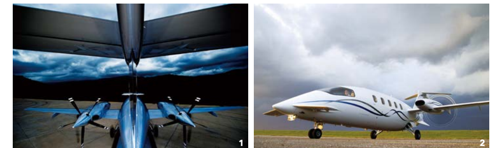
1, 2 고효율 비행용으로 설계된 5엽 프로펠러가 프랫&윌트니사의 터보프롭 엔진 뒤에 장착돼 있다. 3 피아지오 에어로 P180 아반티 II는 수평 꼬리 날개에 더해 가수에 카나드까지 갖춘 독특한 스타일의 항공기다.
