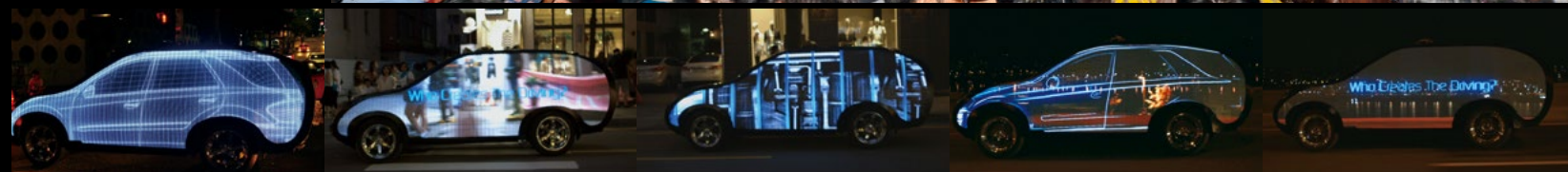
한쪽으로만 휘는 플렉서블 LED 패널의 특성 때문에 작업이 수월하지 않았다. 디지털 크리에이티브카는 수많은 시행착오와 튜닝을 거쳐 80일 만에 완성됐다.
