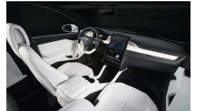
뒷문이 위쪽으로 열리는(왼쪽) 테슬라 모델 X는 3열 7인승(맨 아래) 전기 SUV다. 센터페시아에 자잘한 스위치나 다이얼 대신 17인치 터치스크린이 자리 잡고 있다(위).
