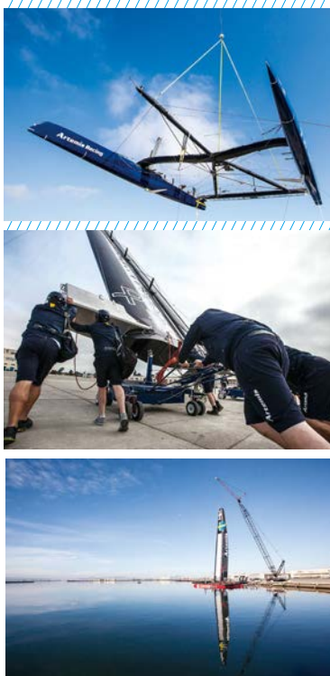
스웨덴 팀인 아르테미스 레이싱의 AC72 진수 장면. 캐터머런 선체를 크레인으로 들어 올려 바다에 띄운다(위). 길 이 22m인 선체와 높이가 40m에 달하는 윈 세일을 인력으로 이동할 수 있는 것은 크기에 비해 가볍기 때문이다(가운데). 윈 세일 역시 크레인에 매단 상태로 선체 중심에 조립한다(아래). ©SANDER VAN DER BORCH/ARTEMIS RACING
