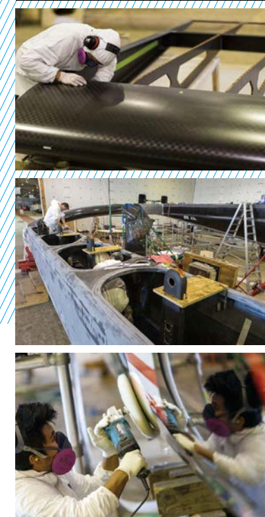
디펜더(지난 대회 챔피언)인 오라클 팀 USA의 AC72 경기정 건조 장면. 탄소섬유 복합재로 만든 윈 세일의 형상은 비행기 날개와 흡사하다(위). 가로대로 결합한 조립한 유선형의 선체 내부 구조를 작업(가운데). 자동차 광택 작업과 비슷해 보이는 과정은 유체 저항을 최소화하기 위한 작업이다(아래). ©GUILAIN GRENIER/ORACLE TEAM USA
